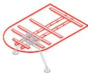
**IT** \* Nota.1 si suggerisce di utilizzare i piani terminali da 183 cm 1NM0313 con il piano intermedio da 120 cm 1NM0073 per avere un passo costante delle basi di 120 cm. \* Nota.2 Modello rappresentato con piano (L.183) in laminato FL. I supporti sottopiano variano di numero in relazione alle finiture cristallo, laccato e legno.
