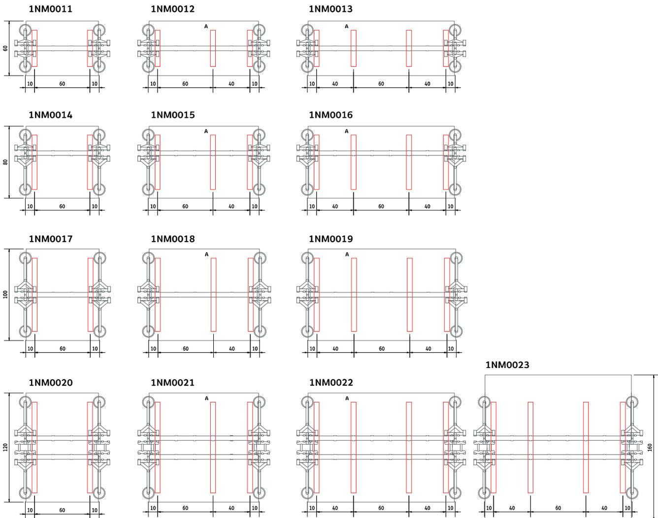
**IT** La posizione e la quantità degli elementi d'irrigidimento è calcolata in funzione delle caratteristiche del piano, sia in lunghezza che di finitura. I disegni rappresentano i piani in laminato. Nel laccato gli elementi d'irrigidimento sono minori (si elimina l'elemento A).
