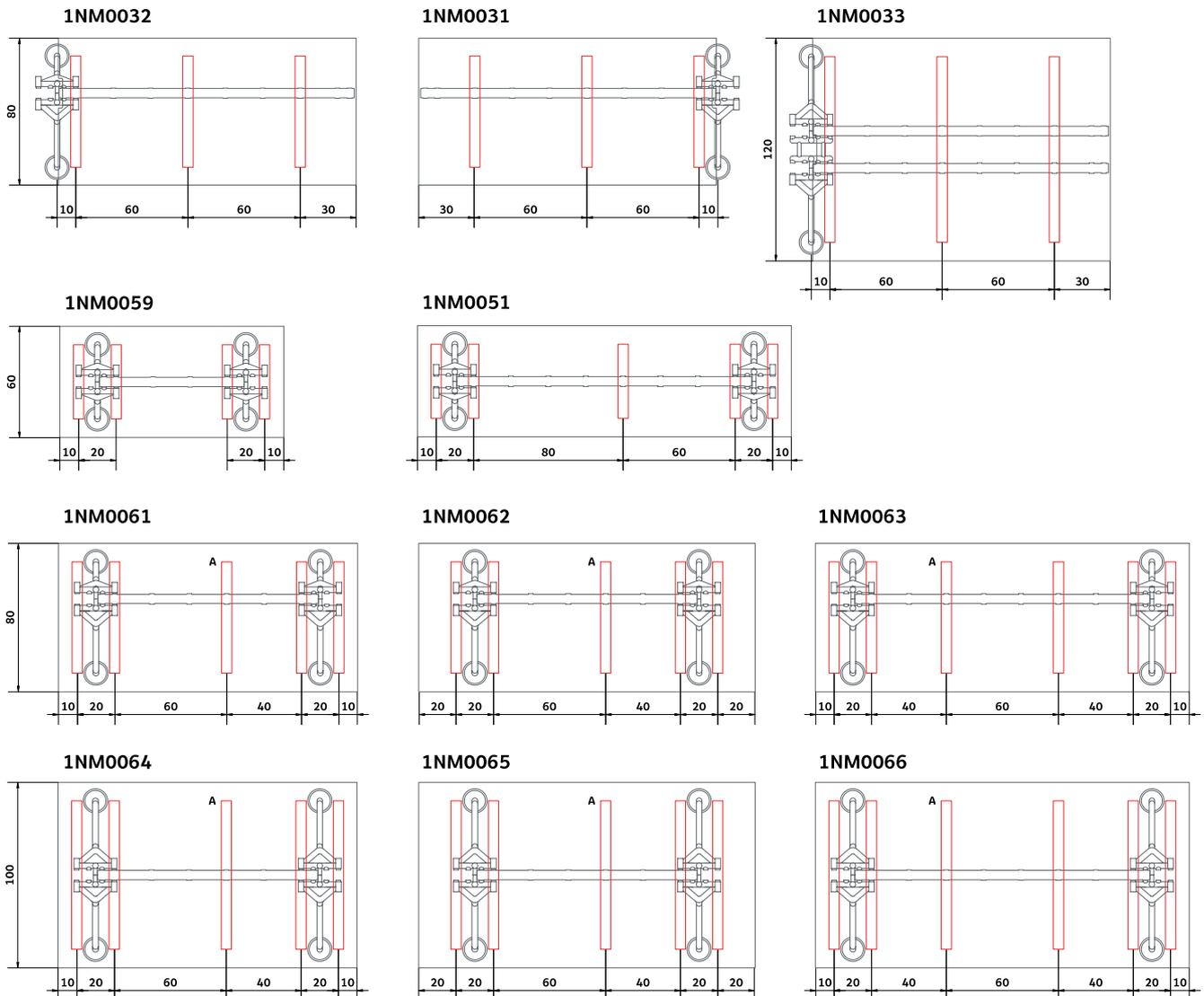
**IT** La posizione e la quantità degli elementi d'irrigidimento è calcolata in funzione delle caratteristiche del piano, sia in lunghezza che di finitura. I disegni rappresentano i piani in laminato. Nel laccato, legno e cristallo gli elementi d'irrigidimento sono minori (si elimina l'elemento A).
